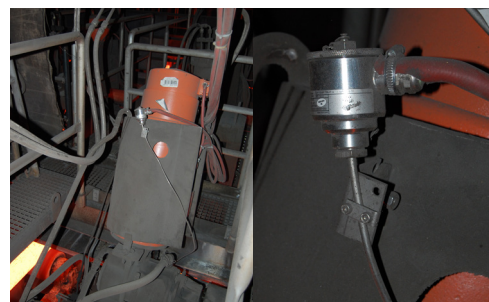
TRA-P14 kopplingshuvud monterat på motorns vattenkylda beklädnad
